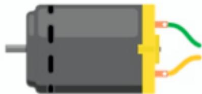
Самый простой вид мотора — коллекторный. При подаче напряжения в одном направлении вал крутится по часовой стрелке, в обратном направлении — против часовой.
