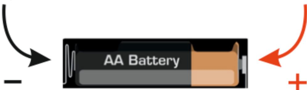
При последовательном подключении батареек, увеличивается напряжение:  $1.5 + 1.5 = 3$  Вольт.
